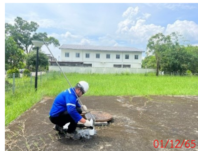
จุดเก็บตัวอย่างน้ำจากบ่อพักน้ำหลังผ่านระบบบำบัดน้ำเสีย
