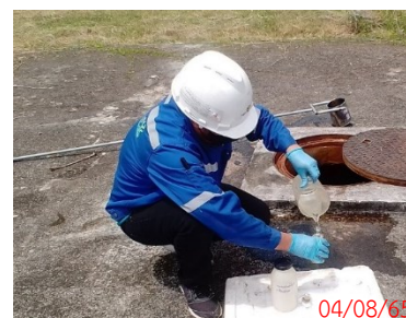
จุดเก็บตัวอย่างน้ำจากบ่อกักน้ำหลังผ่านระบบบำบัดน้ำเสีย
