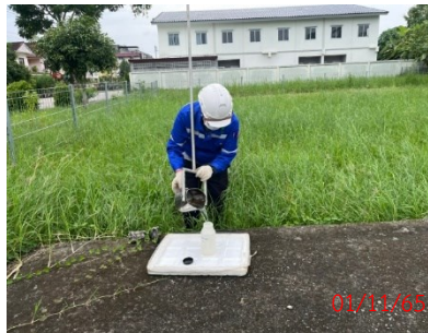
จุดเก็บตัวอย่างจากบ่อพักน้ำจากบ่อพักน้ำสุดท้ายก่อนระบายออกสู่แหล่งน้ำสาธารณะ
